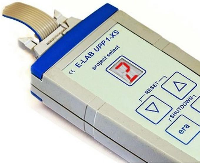
Mit den Pfeiltasten der Version **S** kann der User eines aus bis zu 10 auf der Flashkarte gespeicherten Projekte auswählen. Daher ist diese Version besonders für Reparatur Zwecke und Service als auch für Klein-Serien Programmierung geeignet.
