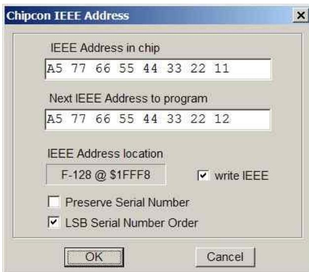
Da der CC2430 ein ZigBee Device ist muss der Controller eine feste Adresse haben (IEEE), vergleichbar mit einer MAC Adresse bei Ethernet. Chipcon hat festgelegt dass diese Adresse (8 Bytes) auf den letzten 8 Bytes des Flash liegen soll. Beim F128 wäre dies \$1FFF8..\$1FFFF.
