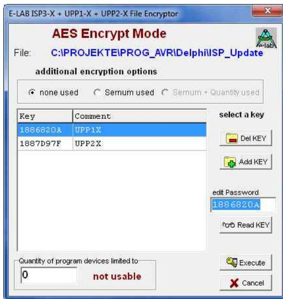
Zum erzeugen eines AES PAC ist es unabdingbar, dass ein „X“ Programmer am PC angeschlossen ist.
