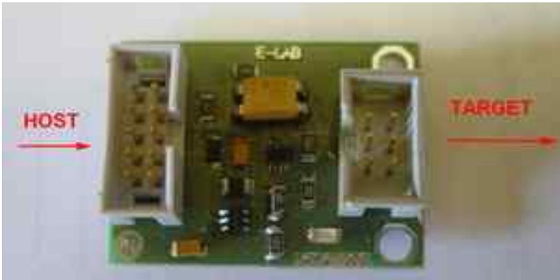
Ist das 12V (HVP) Reset notwendig dann kann mit angeschlossenem HVP Adapter diese in Frage kommende Fuse zurückgesetzt werden.
