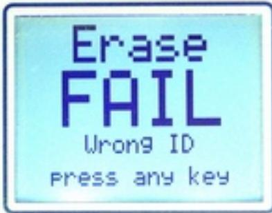
Wurde ein Chip Erase ausgewählt erfolgt unmittelbar nach den obligatorischen Prüfungen eine ok oder fail Anzeige.
