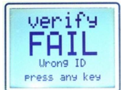
Wurde mit der select Taste ein Verify gestartet, so erfolgen zuerst ein paar Prüfungen. Die notwendige Stromversorgung wird geprüft und auch die ID des Prüflings, soweit vorhanden. Dann erfolgt ein Kommunikations Test. War alles in Ordnung dann erscheint die Verify Anzeige mit einem Fortschritts Balken, wobei zuerst das Flash angezeigt wird und dann das EEprom, falls vorhanden.
