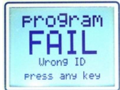
Wurde mit der select Taste die Programmierung gestartet, so erfolgen zuerst ein paar Prüfungen. Die notwendige Stromversorgung wird geprüft und auch die ID des Prüflings, soweit vorhanden. Dann erfolgt ein Kommunikations Test. War alles in Ordnung dann erscheint die Programming Anzeige mit einem Fortschritts Balken, wobei zuerst das Flash angezeigt wird und dann das EEprom, falls vorhanden.
