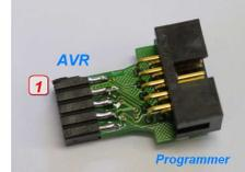
Als Option ist ein Adapter von E-LAB 10pin JTAG auf Atmel 10pin JTAG erhältlich #2127
