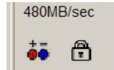
Das Batterie Symbol ist sichtbar wenn der Programmer das Target mit Spannung versorgen muss.
