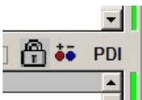
Das Schloss bedeutet hier, dass für das Projekt der Ausleseschutz (Lockbits) für die Ziel CPU aktiviert ist. Das Netzteil Zeichen bedeutet, dass der UPP (für das momentan im PC geladene Projekt) das Target System mit Strom/Spannung versorgen muss.
