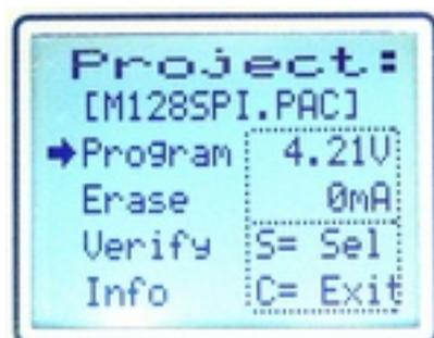
Die wesentlichen Parameter des aktuell geladenen Projekts werden dann in diesem Dialog angezeigt. Ganz oben steht der Datei Name. Rechts darunter wird die Spannung des Targets angezeigt und falls dieses vom Programmer mit Spannung versorgt wird, wird auch dessen aktuelle Stromaufnahme angezeigt.
