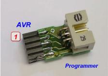
Als Option ist ein Adapter von E-LAB 6pin SPI auf AVR 10pin SPI erhältlich #2125
