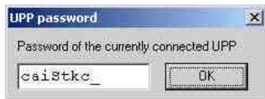
Braucht man für das Verschlüsseln eines UPP1-X Projekts den Schlüssel bzw. Passwort eines UPP1-X Programmiers, so kann dieser mit Hilfe obigen Menu Punktes herausgefunden werden. Der Benutzer dieses Programmiers teilt diesen Schlüssel dem Projekt bzw. Datei Ersteller mit. Letzterer muss den Schlüssel in untenstehenden Dialog eintragen.
